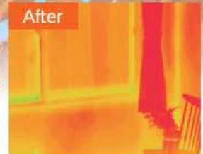
単板ガラス+内窓インプラス (Low-E複層ガラス)
